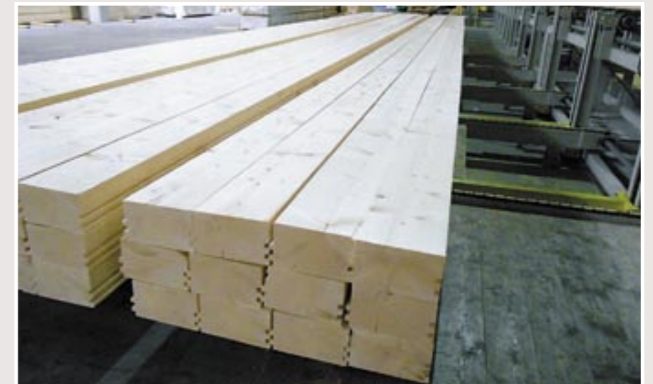
KVH Dielendecke mit 20 Meter Länge
