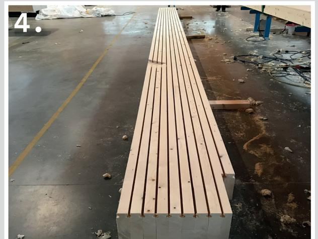
1. Akustikdübeldecke mit Ausfällung im Auflagerbereich
